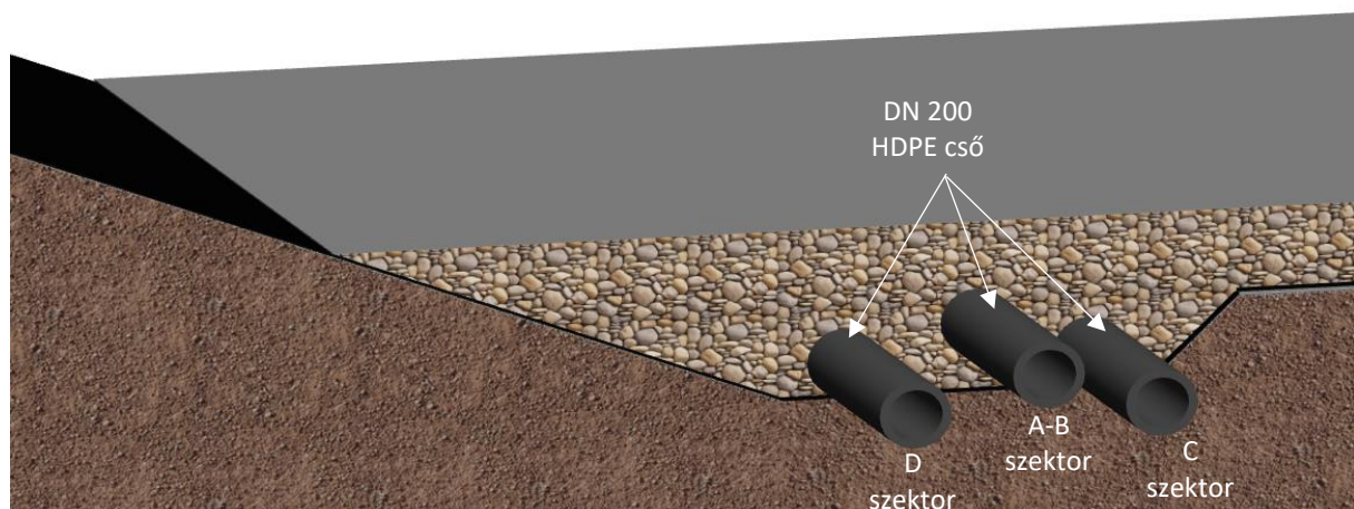
A főgyűjtő vezeték elhelyezkedése a belső oldali rézsűláb mentén
